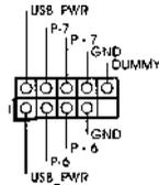
除了位於 I/O 面板的四個 USB 2.0 接口之外，這款主機板有四組 USB 2.0 接針。每組 USB 2.0 接針可以支援兩個 USB 2.0 接口。
